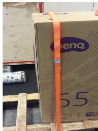
3. Ziehen Sie das Band durch den Verschlusschieber und sichern Sie es.
